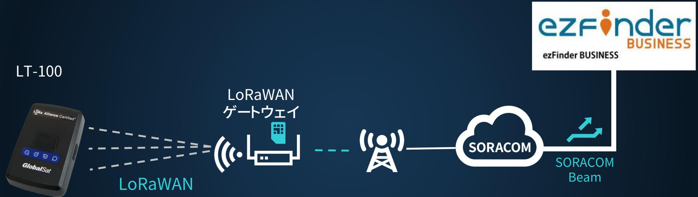
SORACOM ゲートウェイ/LoRaプラットフォームとの相互接続試験が完了
