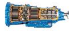
乗用車用 マルチステージハイブリッド トランスミッション
